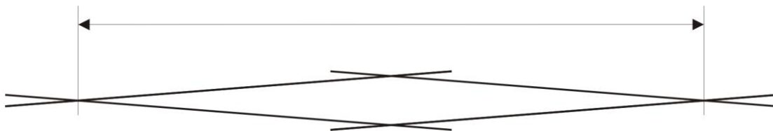
Slika 1 Pravilno merjenje velikosti očesa na mreži - meri se dolžino odprtine med nasprotnima vozlova.
